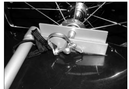
Verriegeln Sie den Bolzen durch Umlegen des Federclips. Der Bügel muss nach dem Schliessen den Bolzen umschliessen.
