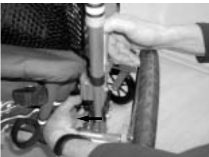
Zum Falten werden die Arretierungen jeder Seite einzeln gelöst.
