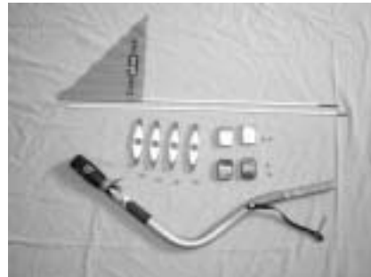
Fahrrad-Set „Weber“: Weber-Deichsel ohne Kupplung, Front-, Rück- und Speichenreflektoren, Wimpel. Es kann zwischen der Weber-Ständerkupplung (Weber B) und der Weber-Achskupplung (Weber E) gewählt werden (s. Kapitel 2.3.3.).
