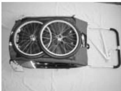
Fahrgastzelle mit Kombiverdeck zusammengefoldet, zwei 20“-Lauf­räder, Schiebebügel, Feststellbremse
