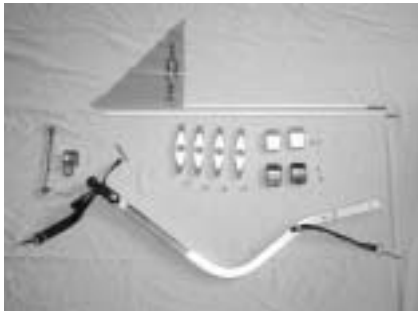
Fahrrad-Set „Achse“: Chariot-Deichsel mit Achskupplung und Schnellspanner, Front-, Rück- und Speichenreflektoren, Wimpel.
