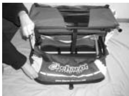
Nach Lösen der Transportsicherung mit einer Hand den Rahmen nach unten, mit der anderen den Aufbau nach oben drücken.
