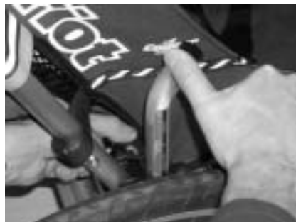
Ziehen Sie den Arretierungsknopf und drücken Sie das kurze gebogene Rahmenrohr nach vorne.
