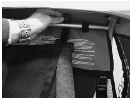
Befestigung des Babysitzes am oberen Rahmen: Montieren Sie die Befestigungsgurte wie abgebildet.
