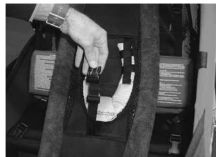
Durchführung des Schrittgurtes auf der Rück- und Vorderseite des Babysitzes.
